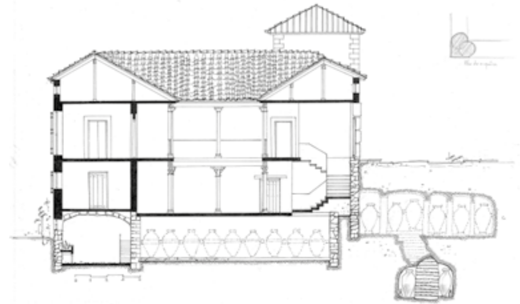
Palacio de los Muelas. SXV. Sección longitudinal
