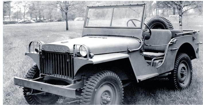
Primer automóvil 4x4 producido en masa, el Jeep Willys puso la funcionalidad y la polivalencia por encima de todo. El acabado era espartano: se trató de un vehículo descubierto de cinco plazas, sin puertas, con parabrisas abatible. Su motor de 2.197 cm<sup>3</sup> con cuatro cilindros en línea desarrollaba 60 CV y destacaba por su fiabilidad.
