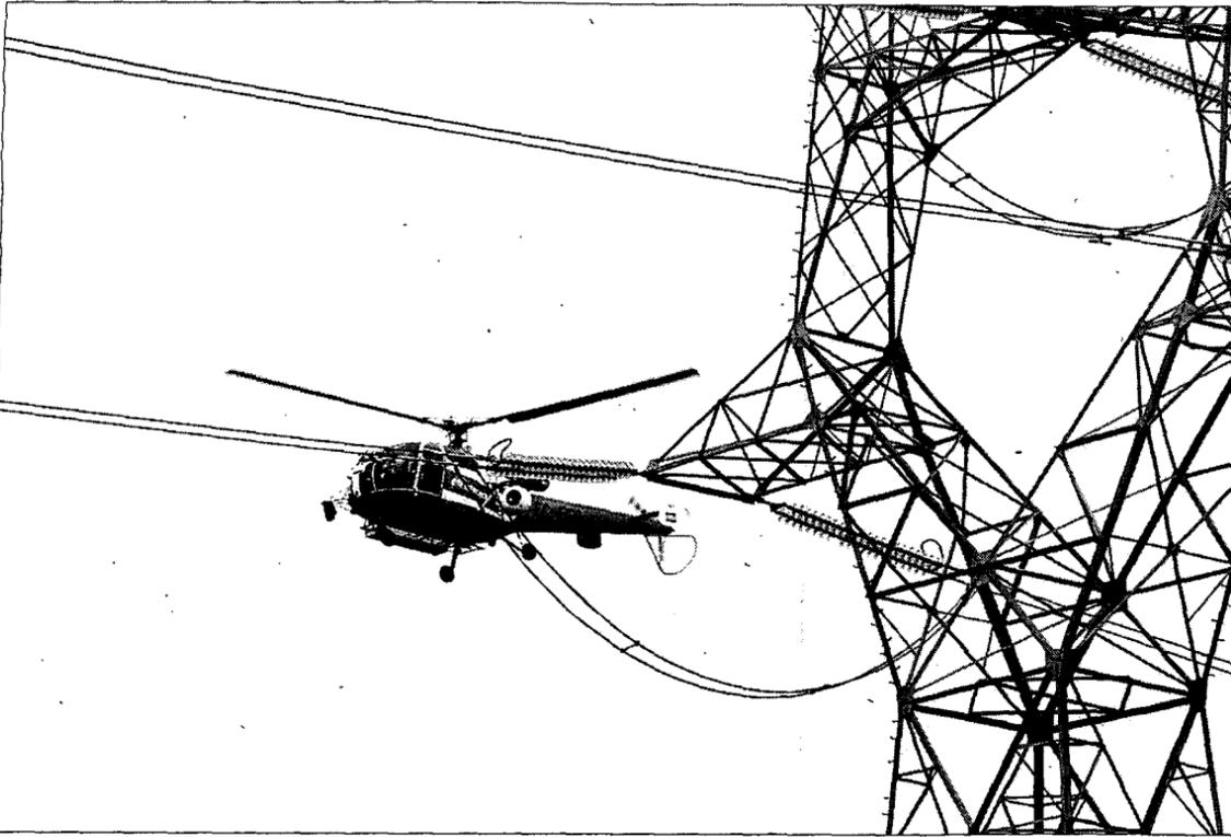
Imagen del helicóptero de la empresa suministradora de energía durante la revisión de las líneas eléctricas.
