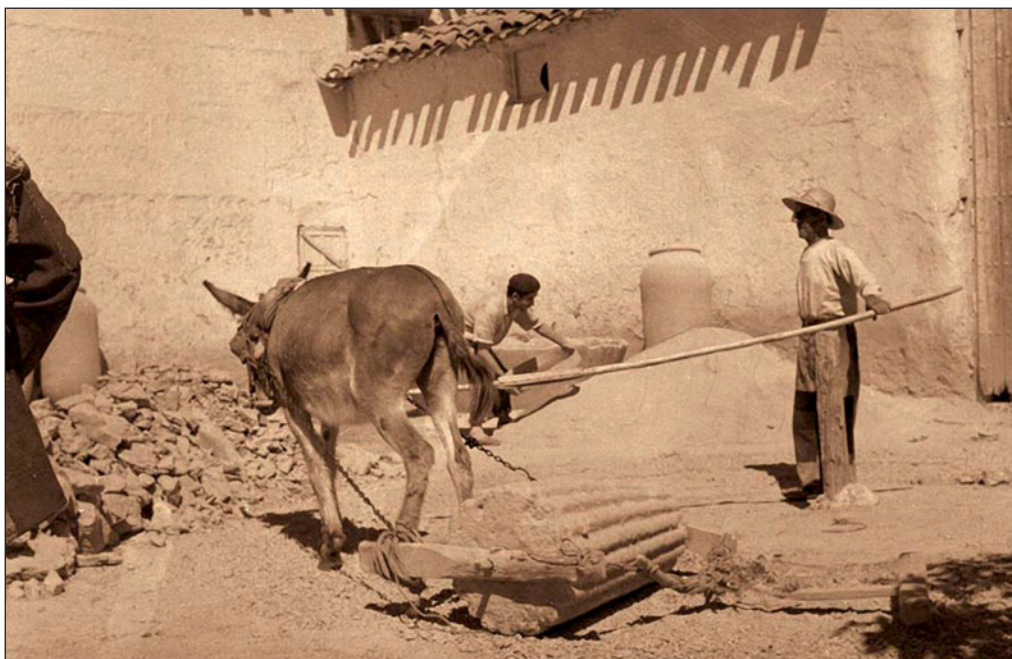
Tiempo atrás el barro para la fabricación de las tinajas se molía con un rodillo de piedra estriado movido por un animal.
