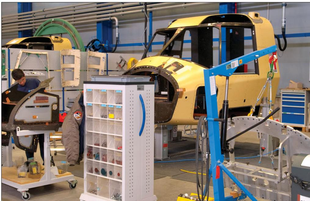
Cadena de montaje del helicóptero NH-90 en la fábrica que Eurocopter mantiene en Albacete.
