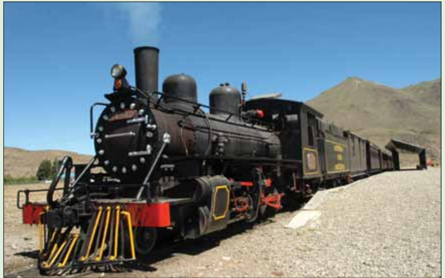
La máquina de vapor convertía el calor en trabajo gracias a unos émbolos que se movían por el vapor.
