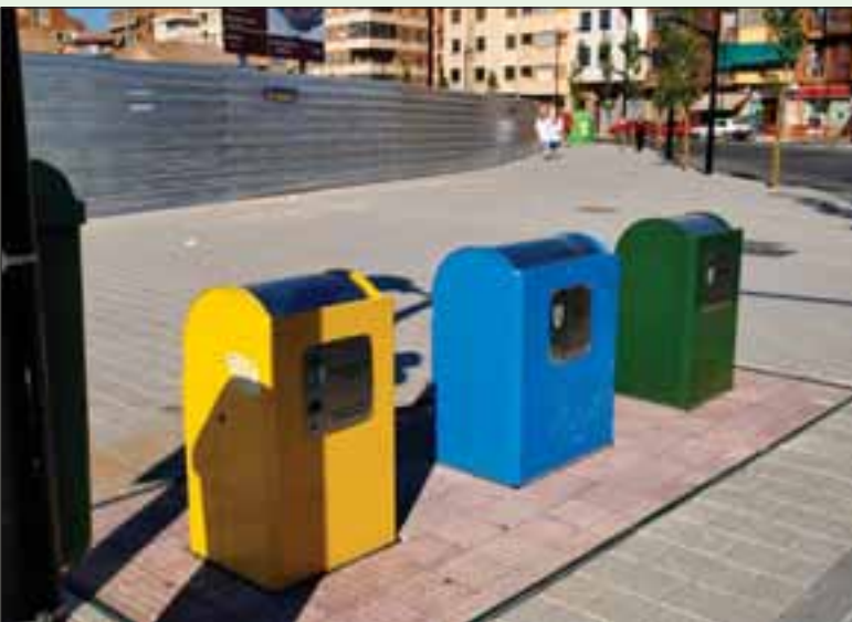
Contenedores con depósito subterráneo situados en el P. de la Circunvalación de Albacete.
