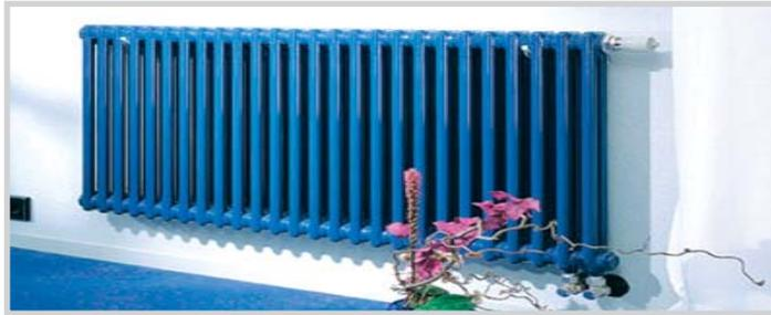
La calefacción caldea la casa mediante una caldera, que calienta agua que circula por tuberías que conectan radiadores adecuadamente repartidos. Estos dispositivos son intercambiadores de calor concebidos para elevar la temperatura de una estancia. Una bomba de circulación impulsa el agua caliente procedente de la caldera hacia estos aparatos.
