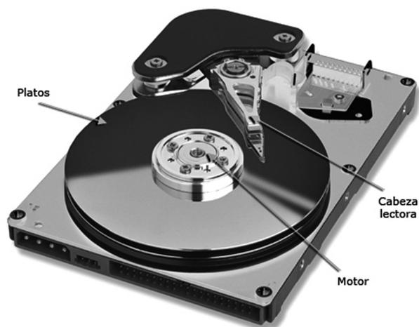
*Plato y cabezal de un disco duro*
