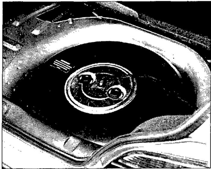
◀ HUECO En el sitio donde en otras versiones del 406 se aloja la rueda de repuesto, en el GPL se instaló el depósito de gas licuado con el que no resta capacidad al maletero. En caso de pinchazos se utilizan dos bombas de aire.
