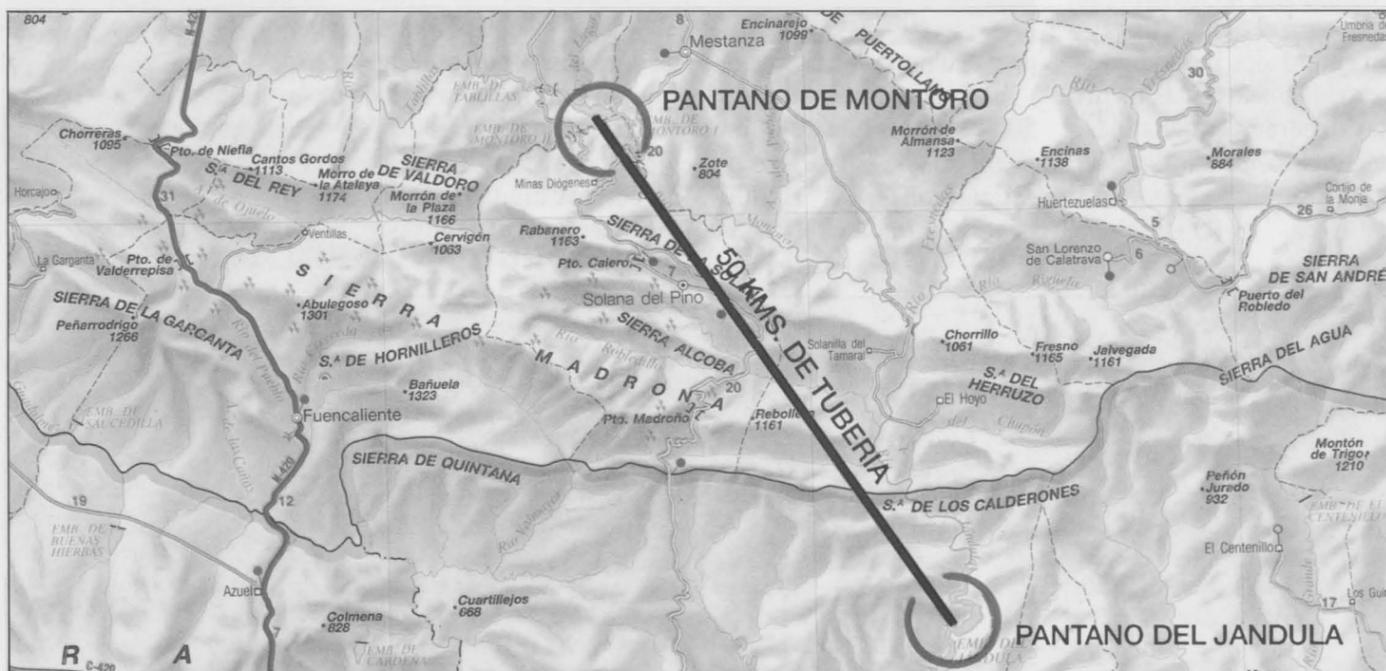
El mapa reproduce el trazado de la tubería que unirá los dos pantanos.
