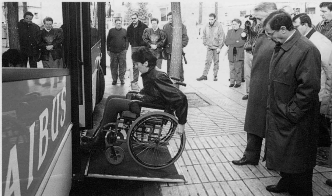
Los autobuses disponen de una rampa motorizada para permitir el acceso con silla de ruedas, así como una zona donde situarse (foto de la derecha), con cinturones de anclaje para asegurar los carros de minusválidos.
