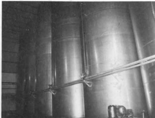
Modernos tanques de acero inoxidable, con capacidad de 100.000 litros cada uno de ellos.
