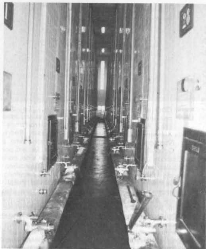
Modernas instalaciones en la bodega "Rodríguez y Berger", con depósitos recubiertos de baldosín para una mejor limpieza.
