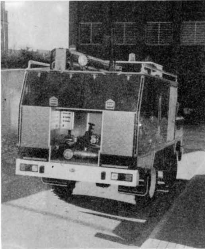
Parte trasera de una de las microbombas todoterreno, con 900 litros de capacidad en su cisterna.
