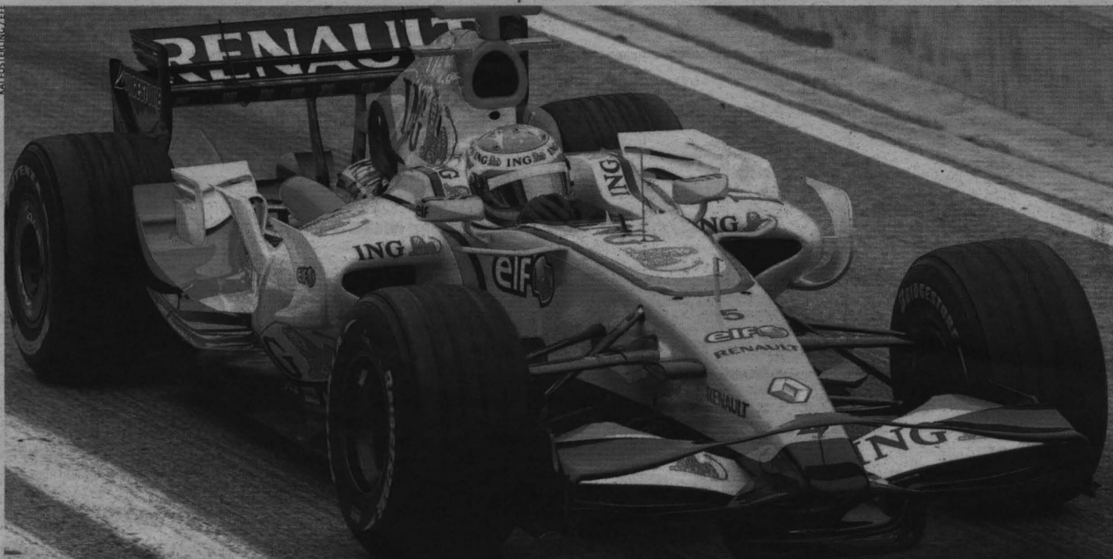
Alonso pilota el R28 en Cheste por primera vez. En el monoplaza destaca su nuevo morro, la mayor diferencia desde el punto de vista aerodinámico con respecto al R27.
