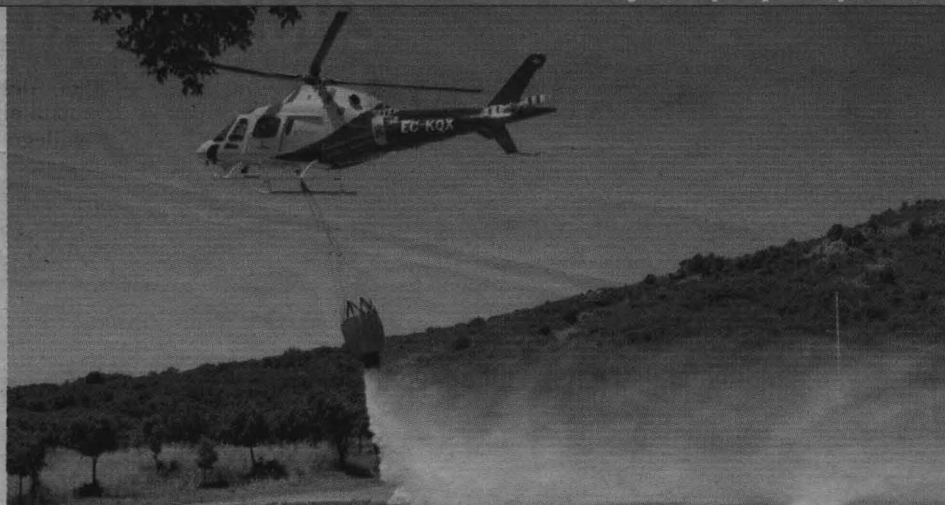
EL HELICÓPTERO. Recogió agua de una balsa cercana y volvió a la base para descargar el agua sobre la pista de aterrizaje. El balde o bambi tiene capacidad para 1.100 litros.
