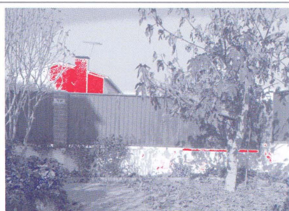
Sección de uno de los canales obtenidos con Histogrammar a partir de la imagen "Toma06.orf" (histograma N° 3) en el que en rojo se indican las zonas sobreexpuestas que se han recortado.
