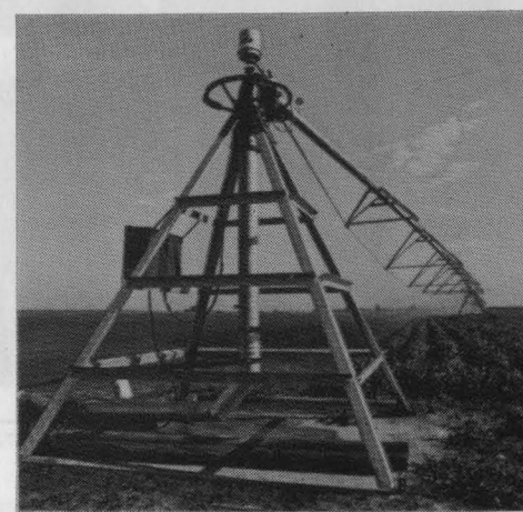
Sistemas de aspersión pivot. Adaptable a topografía ondulada. En la fotografía pequeña se observa el eje o pivote
