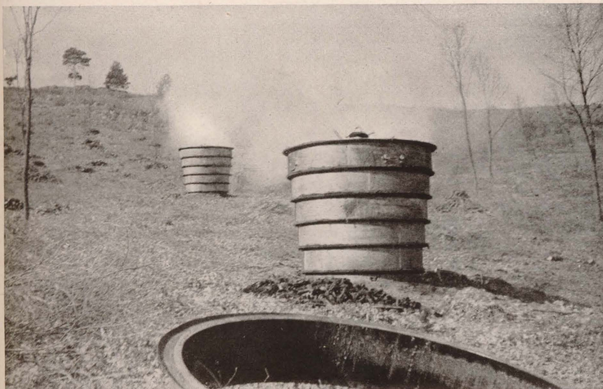
Vista de hornos metálicos autocarbonizadores.
