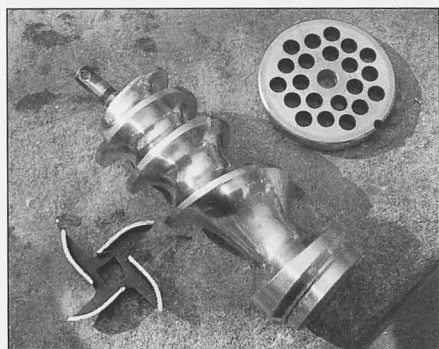
Cuchilla, eje, criba.
