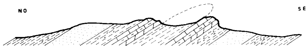
Fig. 14: Corte esquemático, en los materiales triásicos, del anticlinal de Cuchillo Alto.
