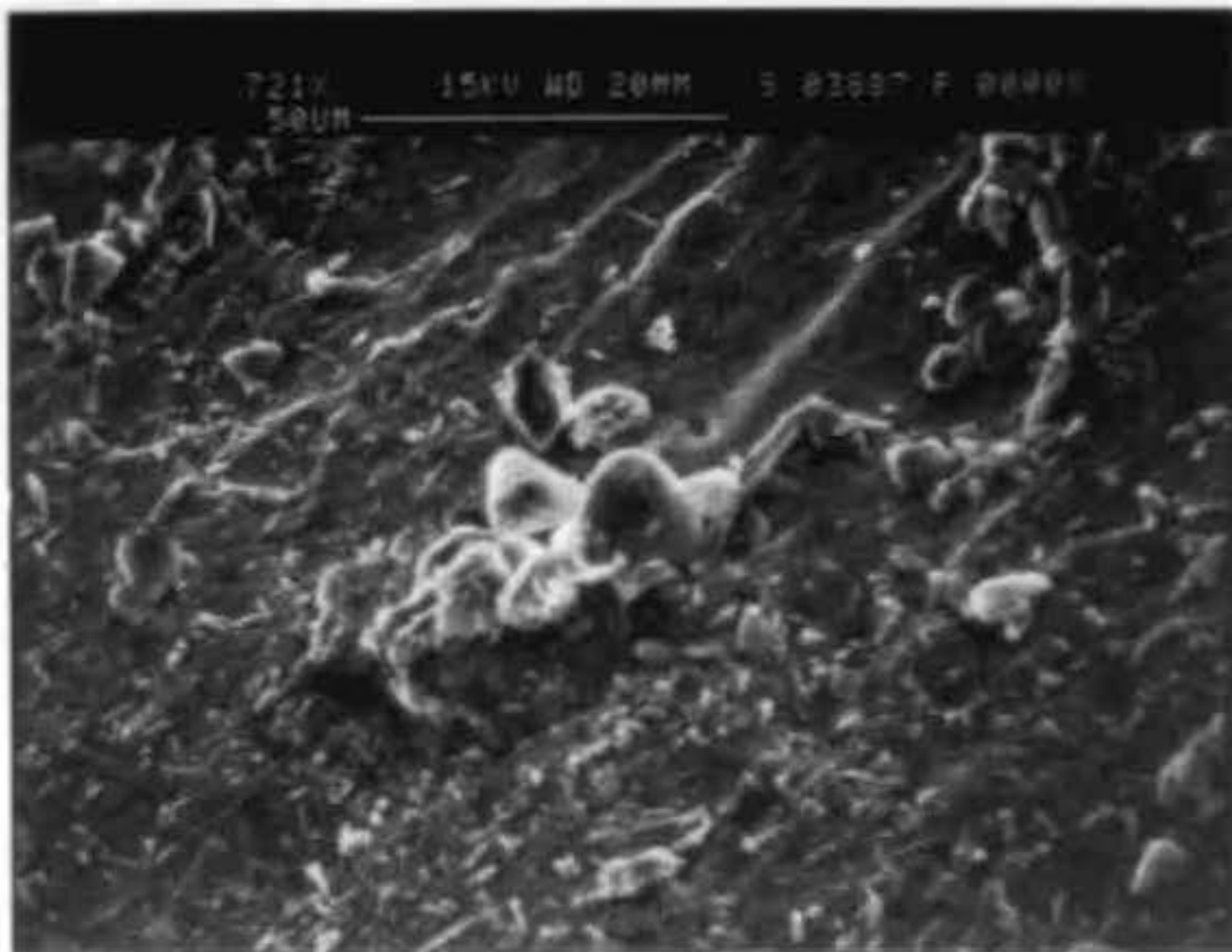
Fig. 46. Microestructura masiva de ópalo C. T. con «silas» en las que se han preservado frústulas de diatomeas bien conservadas, Nódulo de sílex negro centimétrico, trozos de chert de la base de la cantera CEKISA. Imagen de Microscopía Electrónica de Barrido.
