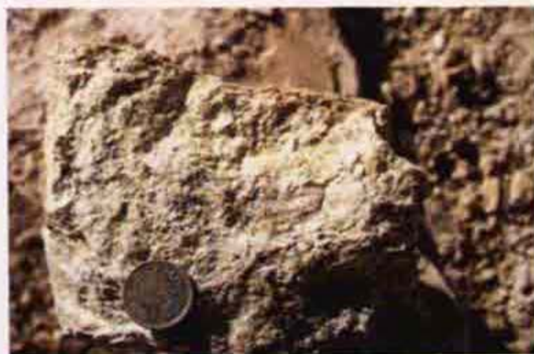
Fig. 19: Mineralización estratiforme macrocristalina de azufre, en el seno de sulfatos. Nótese la potencia pluricentimétrica de los niveles de azufre (color amarillo, sector superior de la muestra). Las Minas.
