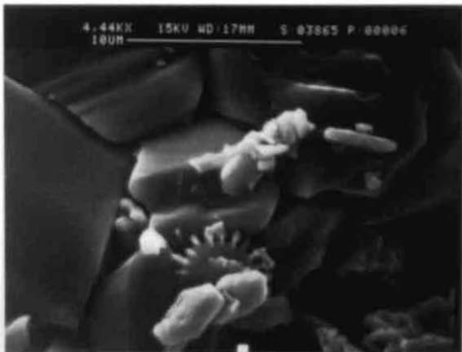
Fig. 43. Detalle de la fotografía anterior en la que se observa la frústula disuelta de diatomita. Imagen de Microscopía Electrónica de Barrido.
