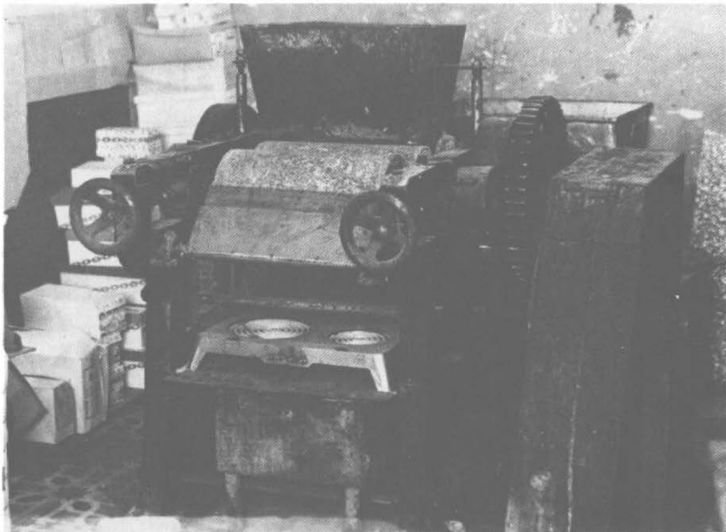
Lám. 5b. Primera refinadora del ingenio hidráulico.
