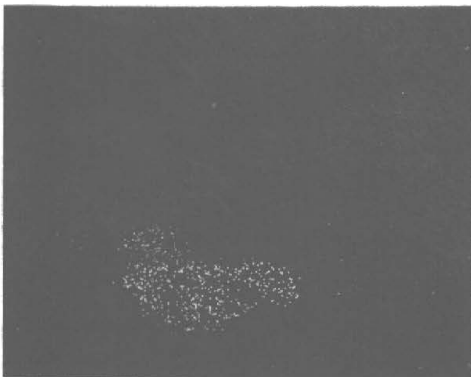
Fig. 8. Imagen de rayos X de la raya K_{\alpha} del azufre de la zona de la fig. 5 ( \times 3.000 ).
