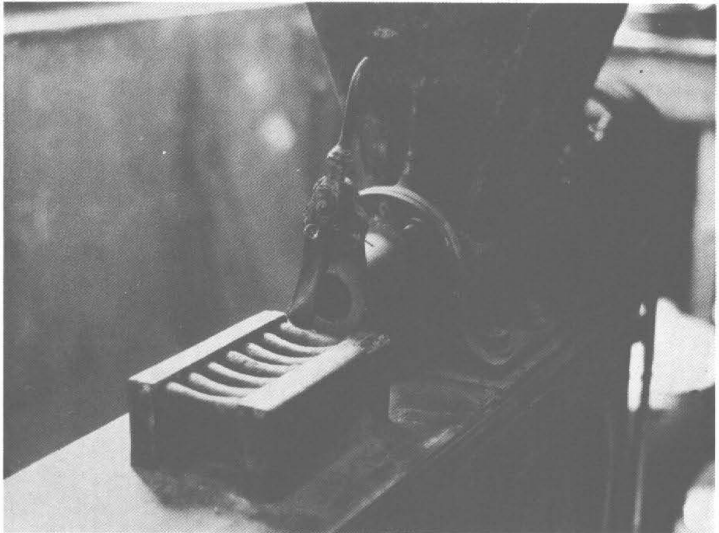
Lám. 6b. Detalle del orificio de salida, en que puede apreciarse la cuchilla, destinada a seccionar las porciones de la pasta.
