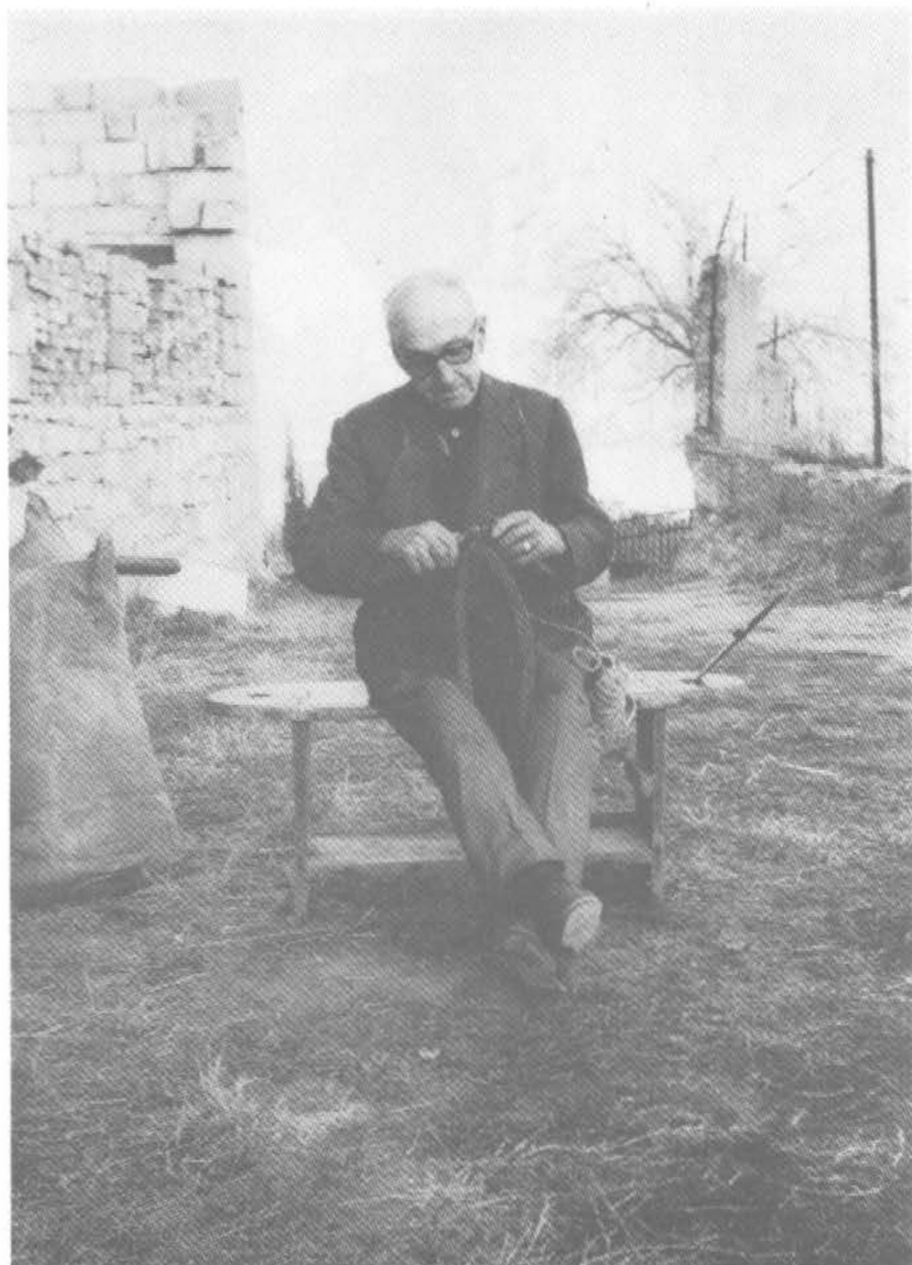
(Lám. I a). El botero sentado en el banco cose con ayuda de las mordazas y los palillos de costura .
