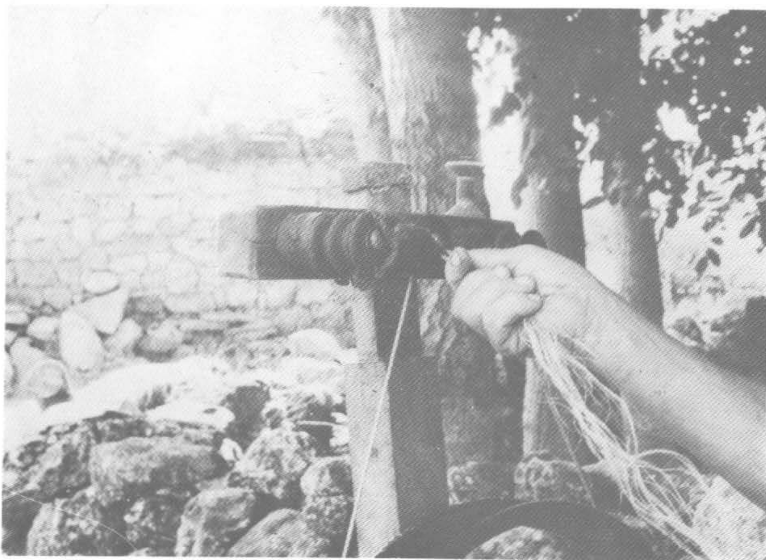
(Lám. V a). Comienza el hilado de las cuerdas sujetando el cáñamo en uno de los tornos .
