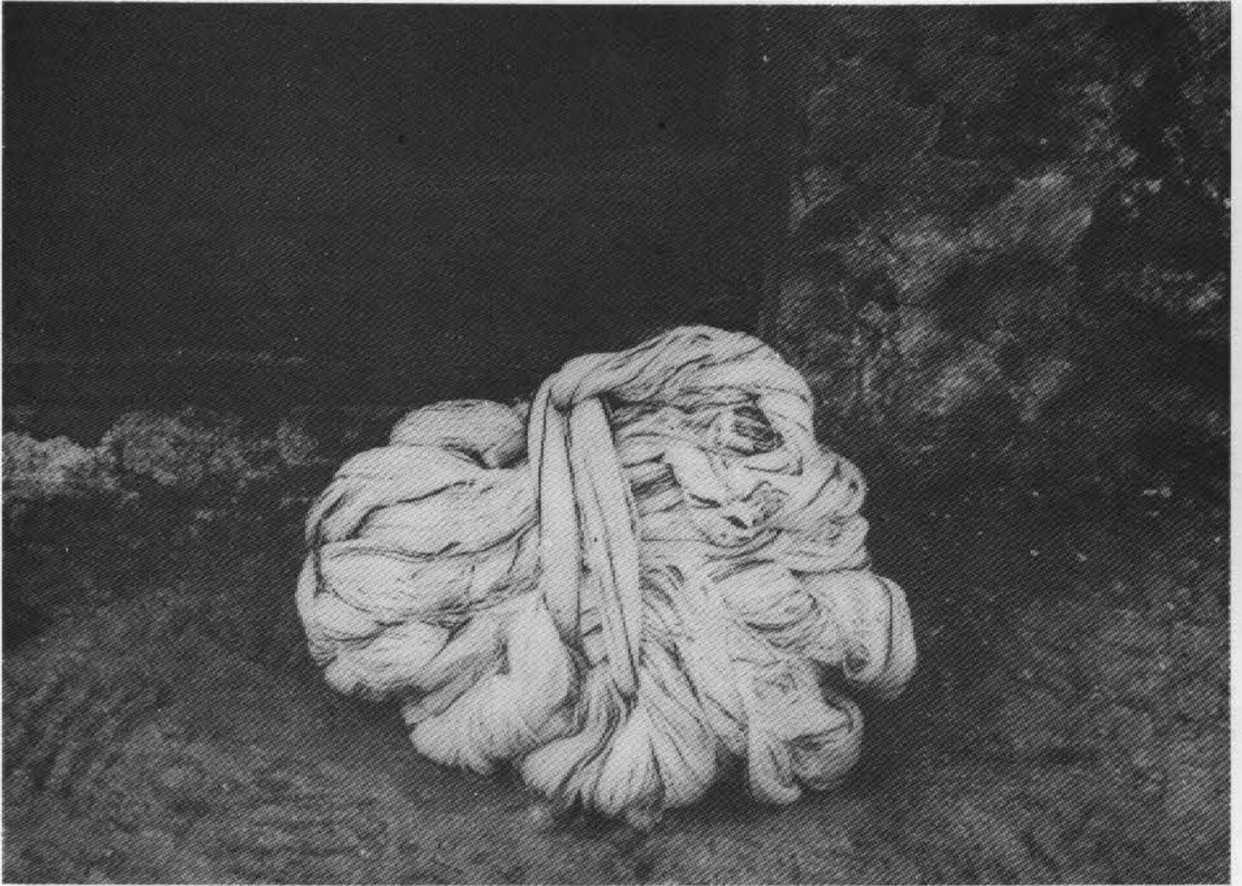
(Lám. VIII a). Pieza urdida dispuesta para ser colocada en el telar.
