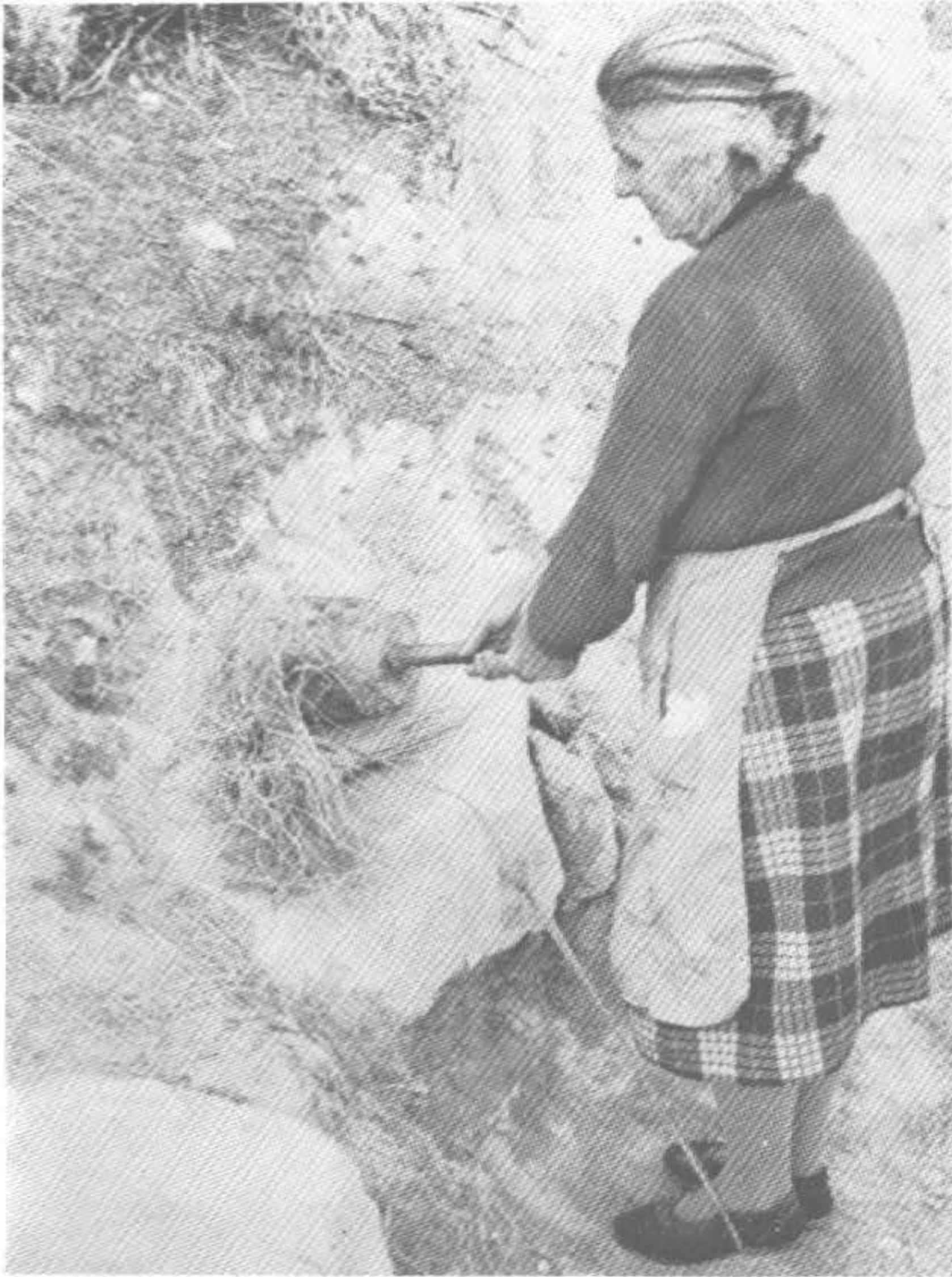
Lámina I - Machacado del esparto cocido. La maza percute contra el manojo colocado sobre la machacadera y sujeto por una lía de esparto tensa entre la estaca y el pie (Illana).
