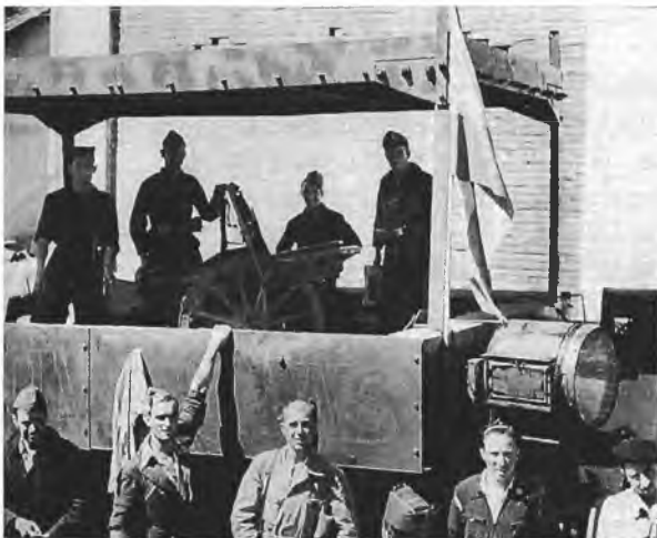
Vagón ametrallador de un tren blindado de tipo "B". Colección particular de Vicente Juárez Martín.
