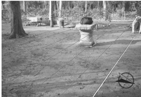
Figura 12. Ubicación y orientación de los perfiles sistemáticos de GPR desarrollados en la zona G-jardines.
