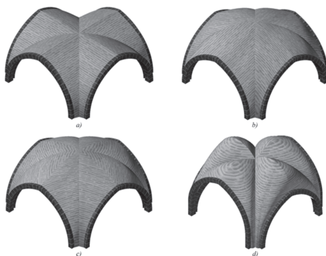
Fig. 5.- Representación ideal de diversas variantes de bóvedas de crucería con los materiales empleados en Calatrava la Nueva:
