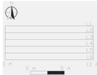
Figura 16. Distribución de los perfiles de tomografía eléctrica en la zona de los jardines.
