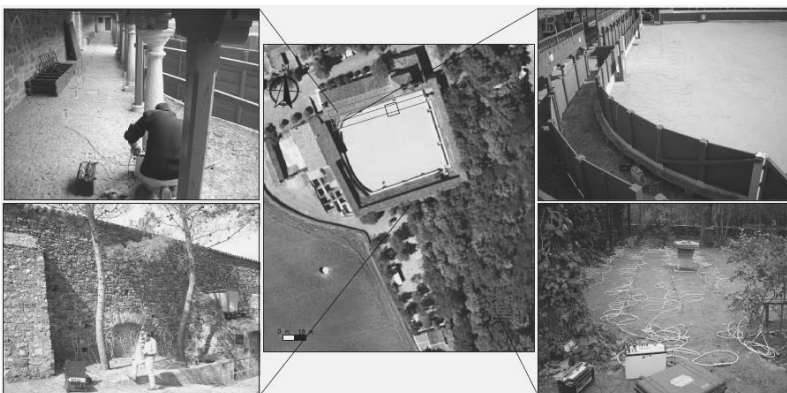
Figura 18. Vista general de las zonas en las que se realizaron las investigaciones sistemáticas con tomografía eléctrica (magenta) y nanoTEM (azul). (A) Galería porticada. (B) Plaza de toros. (C) Exterior plaza de toros. (D) Jardines.
