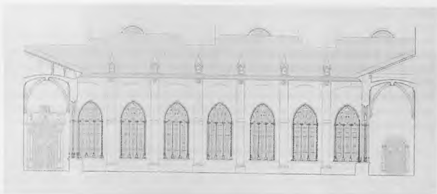
Fig. 13.- Claustro del siglo XVI: Planos de plantas, y alzado sur, con la restitución hipotética de su coronación original (del proyecto de restauración redactado por Eduardo Barceló y José Juste, y de la tesis doctoral del último) .
