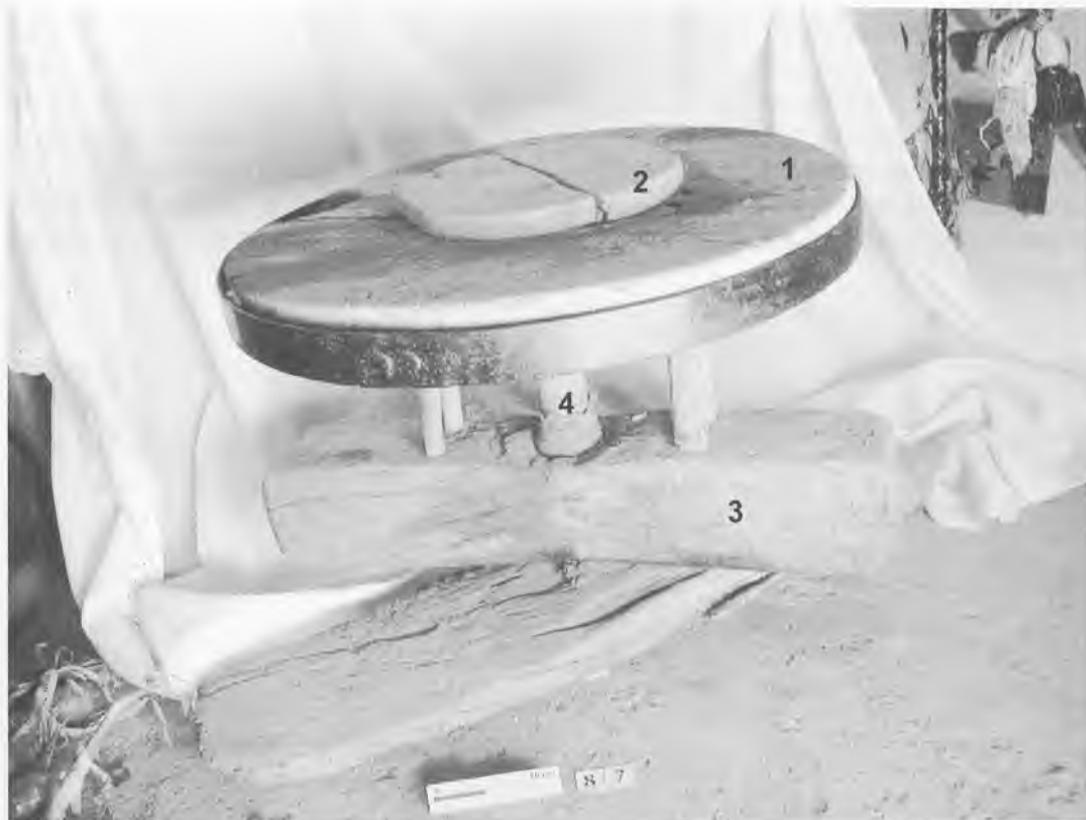
Figura 2. Torno alfarero de Zarzuela de Jadraque con indicación de sus partes: 1 rueda, 2 rodal central, 3 corredera y 4 estaca. Torno propiedad de Basilio Sanz Martín.
