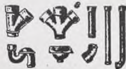
Tubería para bajada de aguas
