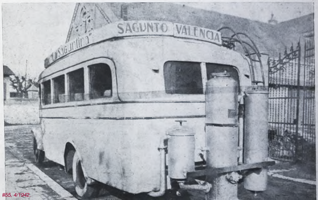
Gasógeno «SANJUAN», montado sobre ómnibus de pasajeros, marca BLITZ, de la línea SAGUNTO-VA- LENCIA
