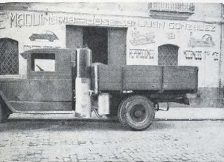
Gasógeno «SANJUAN», montado sobre camión marca 3 H c, pro- piedad de COMISARIA DE ABAS- TECMIENTOS Y TRANSPORTES DE VALENCIA
