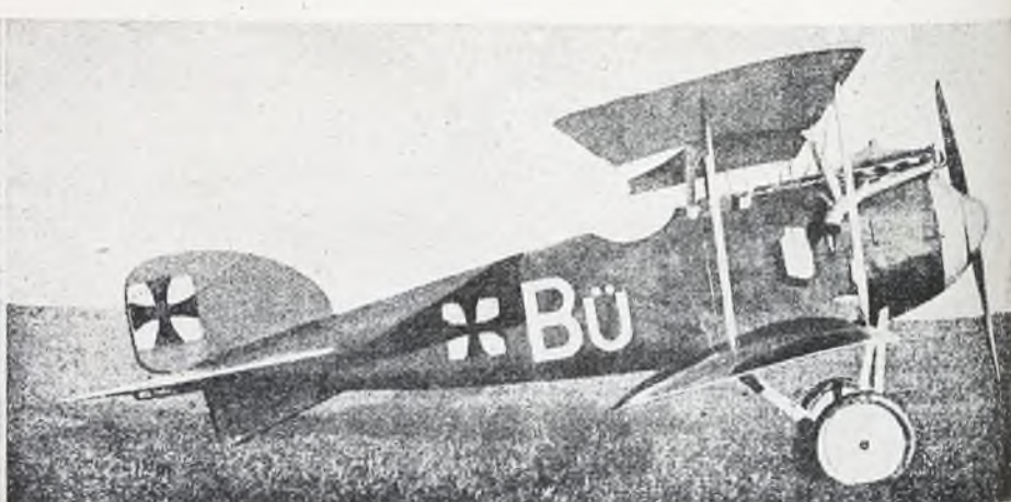
Biplano alemán "Albatros", de caza, tipo D-1, motor "Mercedes" seis cilindros, 170 HP., aparecido a fines de 1916. Este aparato, de aspecto moderno y perfilado, con dos ametralladoras, no pasaba de los 180 kilómetros por hora.
