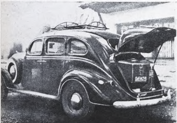
Gasógeno marca "GAS-MOVIL", construido por INDUSTRIAS BERDA, de Arechavaleta, montado en un coche de turismo "Dodge", mod. 1939. Una vez cerrada la tapa del porta-equipajes no puede notarse si lleva gasógeno.
