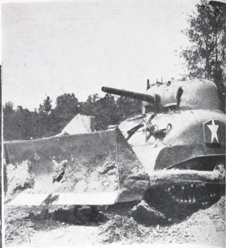
Un tanque norteamericano modelo «Sherman» con una pala en su parte delantera para eliminar los obstáculos que se pongan
