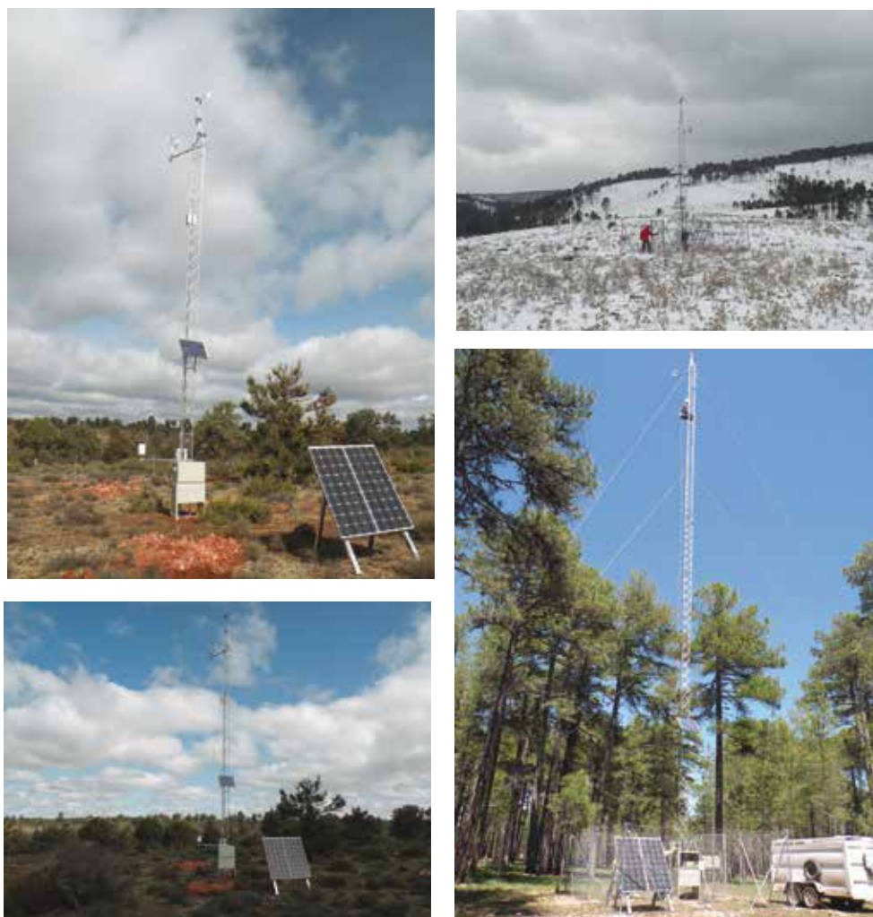
Figura 13.: Fotografías de las torres de flujo “Eddy covariance” en algunas de las zonas forestales de Castilla-La Mancha. (a) El Bonillo, (b) Las Majadas quemado, (c) Las Majadas, (d) Yeste
