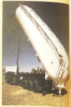
Semiremolque cisterna en aluminio para transporte de pulverulentos.
