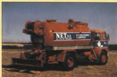
Cisterna para extracción y limpieza de pozos negros.
