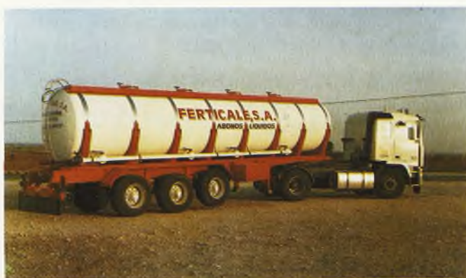
Cisterna con una capacidad de 25.000 litros, homologada con normas ADR.
