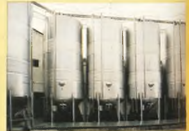
Vinificadores para tintos, de 100.000 lts. de capacidad, con extracción automática de crujeas, remolado programable y perfecto rociado del sombrero con sistema rotativo.
