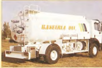
CISTENA REPARTO 15.000 litros - 3 compartimentos - Aluminio - Carga inferior Contador 700 lts./min. - Accionamiento hidráulico
