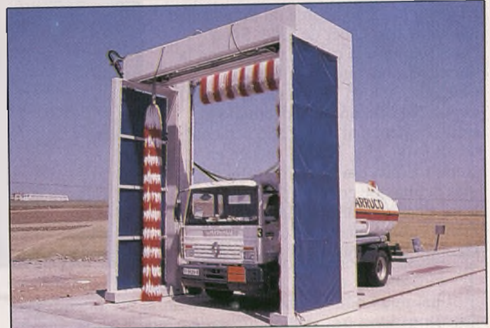
Lavado automático de camiones.
