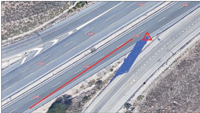
Para completar el nuevo acceso debería eliminarse el ceda el paso dando acceso preferente y cerrando como señalamos en el gráfico el carril derecho que viene de Santa Bárbara.
