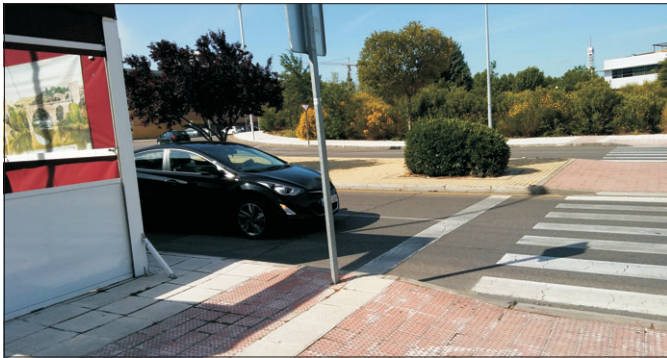
Marquesinas que quitan visibilidad en paso de peatones.
