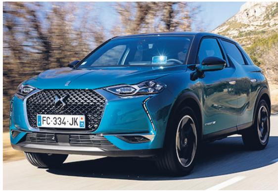
Gracias a un radar, una cámara y varios sensores, el DS 3 CROSSBACK se adapta a las condiciones de la circulación: sigue automáticamente la trayectoria elegida por el conductor en el interior de la vía y regula la velocidad de un modo fluido para respetar la distancia de seguridad, llegando a la detención completa del vehículo, si es necesario. En todo momento, el conductor puede retomar el control.
