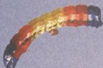
principal, adosado a la espalda (dorsal), de 40 a 80 m<sup>2</sup> y unos 13 kg de peso, y de un paracaídas auxiliar o de emergencia, adosado al vientre (ventral) y de menor dimensión y peso (generalmente, de 30 a 45 m<sup>2</sup> y 5 kg). Aunque existen muchos tipos de paracaídas, difieren muy poco entre sí. Los fabricantes rusos y norteamericanos, así como los alemanes, han logrado un alto nivel de precisión y maestría en el diseño de paracaídas para uso deportivo.
