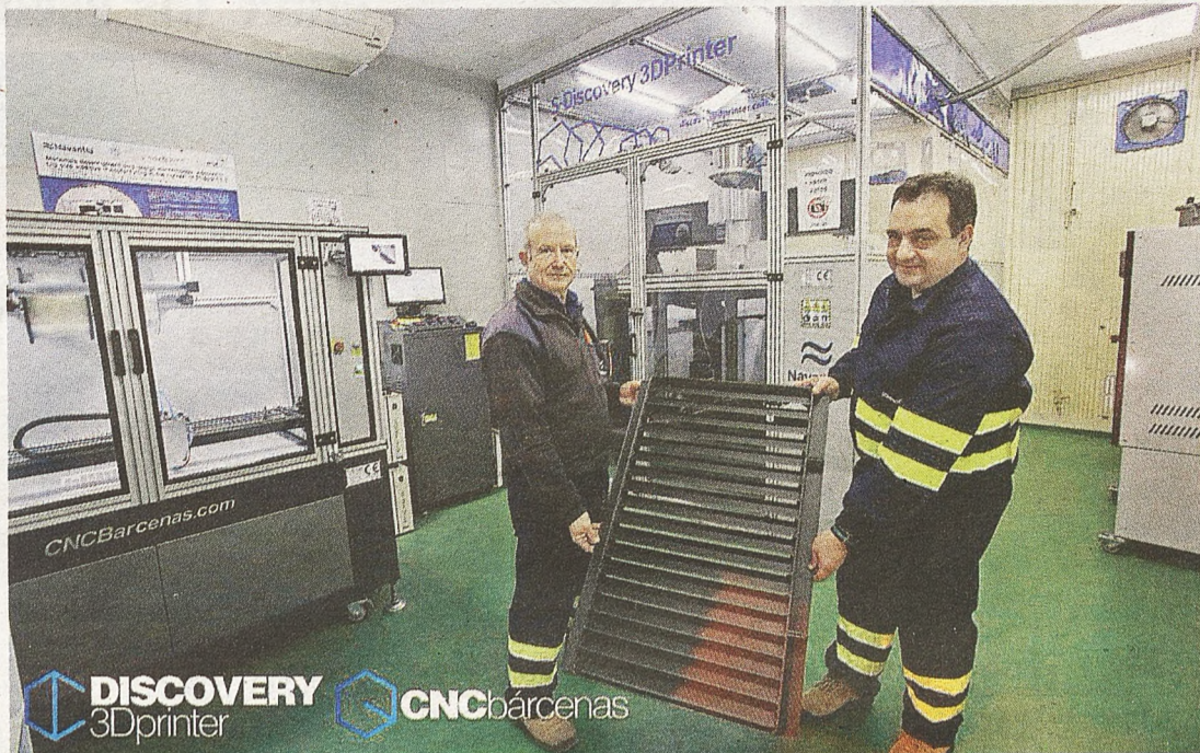
Personal de Navantia muestra una rejilla para uso naval, impresa en 3D en la impresora Discovery que se ve detrás
