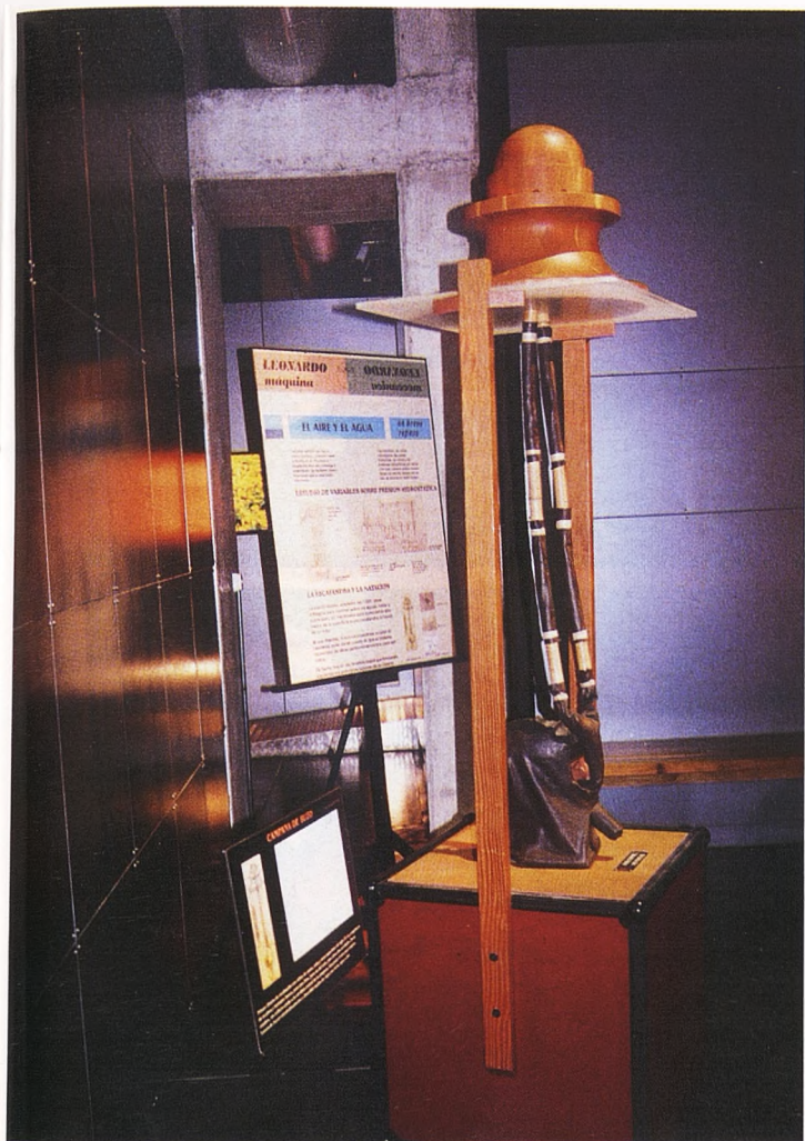
Campana de buzo. La campana de invertida flota en la superficie del agua. De ella salen dos tubos que se conectan a la mascarilla de modo que por uno de ellos entra el aire mientras que por el otro se produce la expulsión del mismo.
