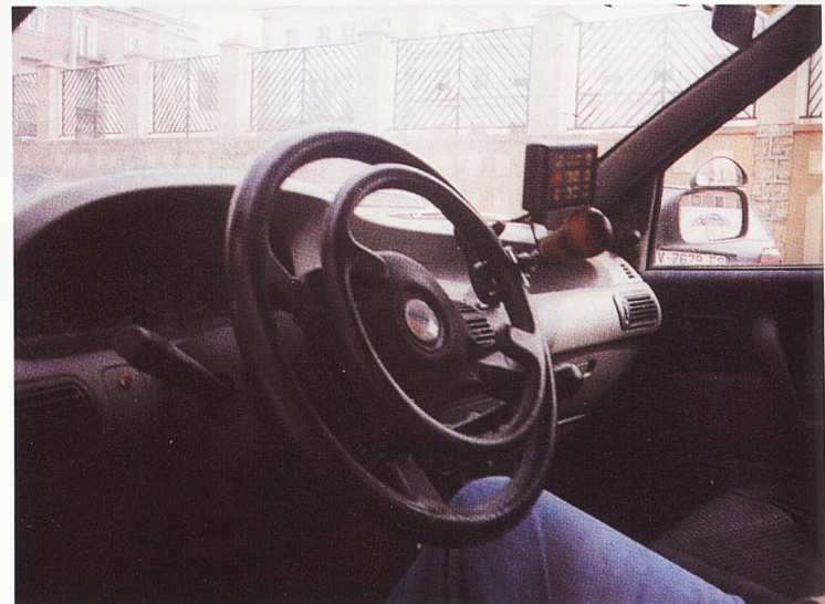
La Federación adquirió un coche adaptado en 1997 para facilitar el aprendizaje de los minusválidos. El doble mando es una de las ayudas técnicas que posee este vehículo.
