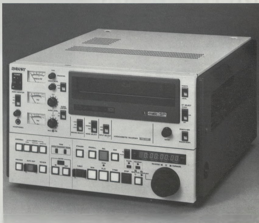
Aparato grabador de video (sistema U-Matic). (Fotografía cedida por cortesía de SONY-Madrid).
