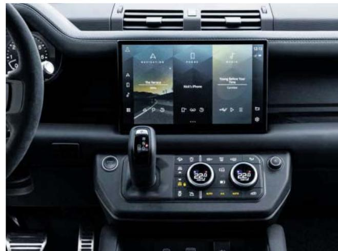
El sistema está controlado por un procesador Intel Multi-Core con una red Ethernet de alta velocidad a través de la pantalla táctil, como una tableta. InControl es el corazón tecnológico de la experiencia del habitáculo de los modelos Jaguar y Land Rover y ofrece un control preciso del entorno, navegación, entretenimiento y seguridad, así como una conectividad inigualable desde cualquier parte del mundo.
