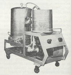
Filfros de placas construídas en ACERO INOXIDA BLE, En uno solo pase abrillanta los vinos para embote lar con mínimo consumo de filtrolina. Varios modelos, según rendimiento
