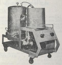
Filtros de placa construída en ACERO INOXIDAB E. En un solo pase abril anta los vinos para embotellar con mínimo consumo de fitro ina.
