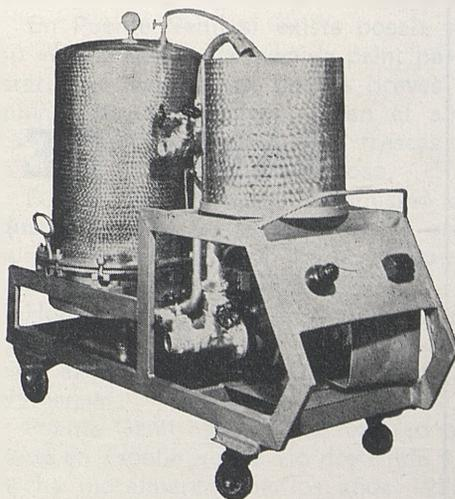
Filtros de placa construída en ACERO INOXIDABLE. En un solo pase abrillanta los vinos para embotellar con mínimo consumo de fitrolina.
