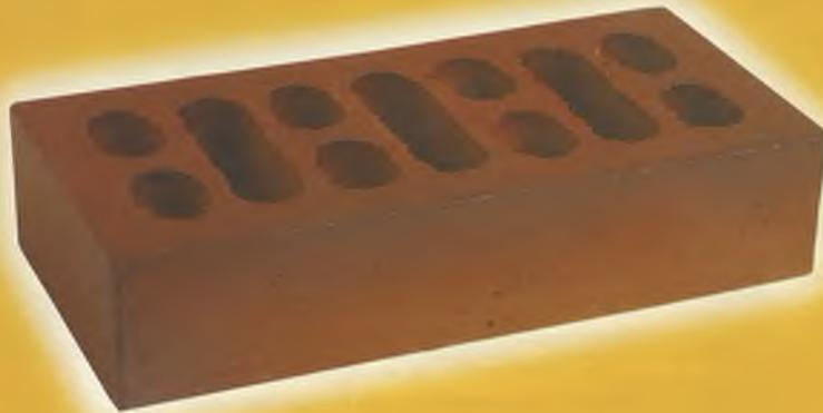
Absorción: 3,5% - Succión: 0,03(g/cm<sup>2</sup> min.) - Resistencia compresión: 500(daN/cm<sup>2</sup>) - Expansión por humedad: 0,10(mm/m) - No eflorescido - No heladizo
